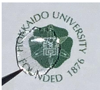
今回開発した柔粘性/強誘電性結晶（透明に見える物質）
